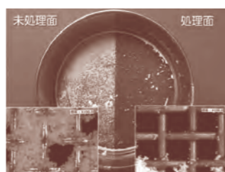
フルイの未処理とWPC処理の小麦粉の目詰まりの違い
