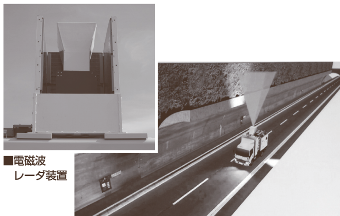
■規制を伴わない高速走行による電磁波レーダ計測状況
