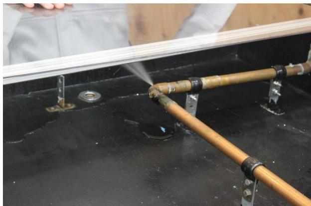
銅管のピンホールからの漏水実験
