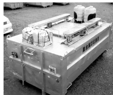
重金属回収装置・洗浄水再使用
